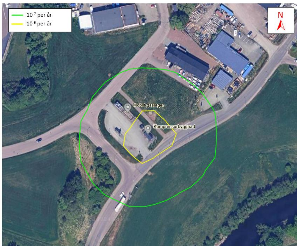
Figur 6-7. Individrisk från gastankningsstation. Grön konturkurva motsvarar individrisknivån 10^{-7} och gul konturkurva motsvarar individrisknivån 10^{-6} .
