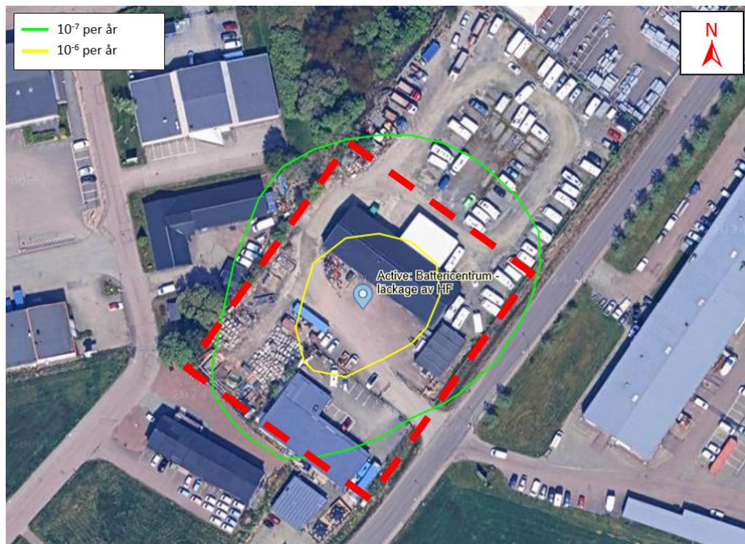
Figur 6-6. Individrisk från battericentrum. Röda streckade linjer visar exempel på var battericentrum kan placeras. Grön konturkurva motsvarar individrisknivån 10^{-7} och gul konturkurva motsvarar individrisknivån 10^{-6} .
