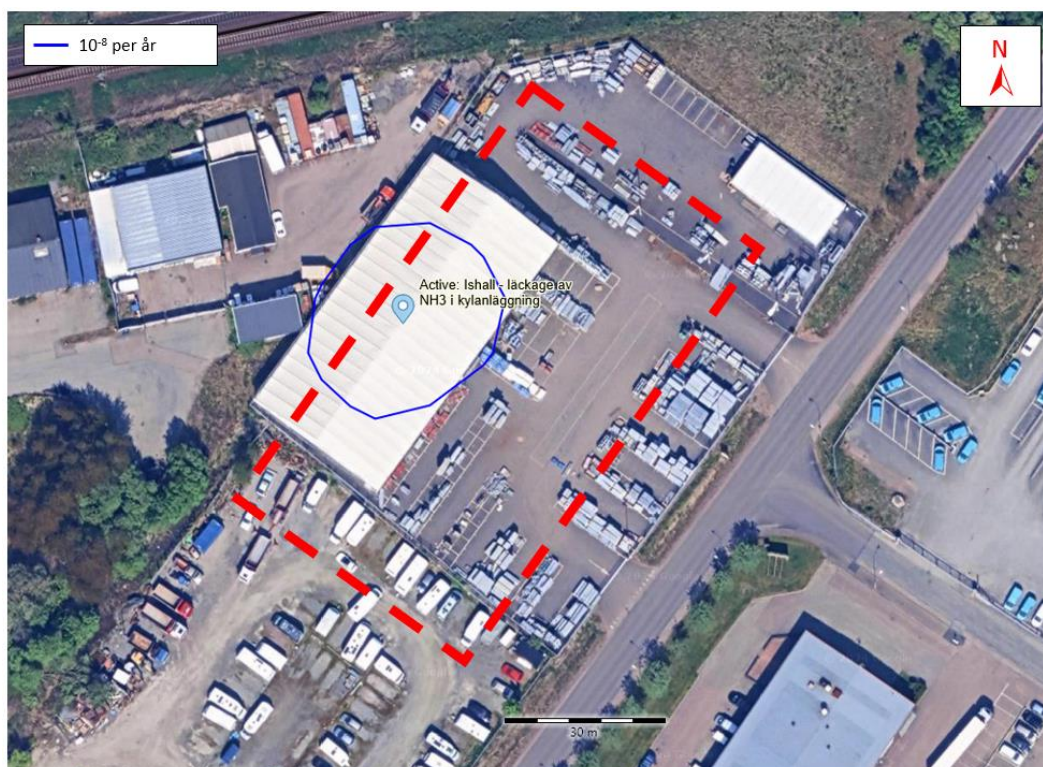
Figur 6-5. Individrisk från ishallen. Röda streckade linjer visar exempel på var ishallen kan placeras. Blå konturkurva motsvarar individrisknivån 10^{-8} .
