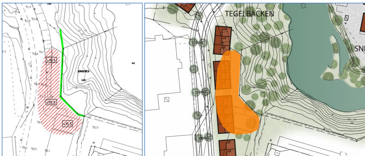
Figur 25: Föreslagna stabilitetsförbättrande åtgärder (avschaktning) för detaljplanen.
