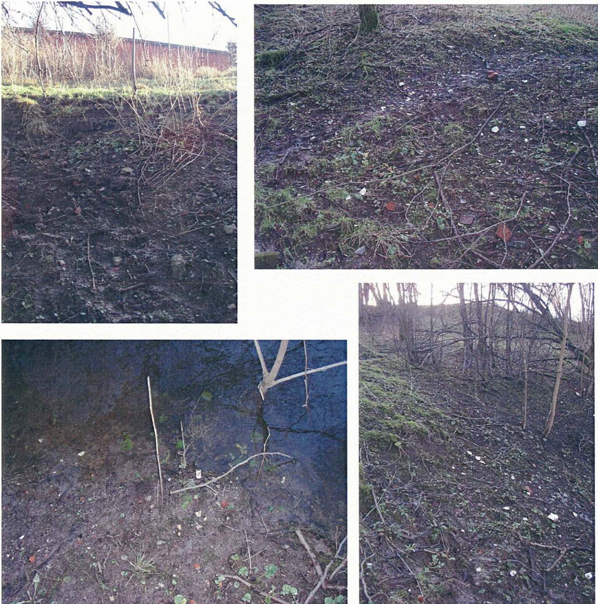
Figur 3. Skredärr mellan undersökningsområdet och Sävveån samt rester av avfall i markytan, observera avfallsrester även ut i Sävveån
