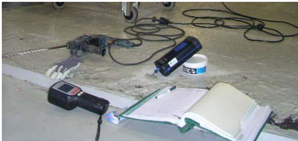
Figur 4. Porgasmätning med CMS och PID med smalhål genom grundläggning
