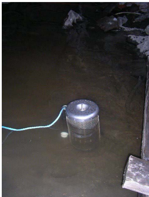
Figur 1. Passiv provtagare utplacerad i dagvattenkulvert, pp38
