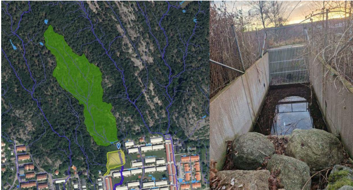
Figur 11. Bild till vänster visar avrinningsområde som rinner in i planområdet utifrån. Bild till höger visar trumman som avleder vatten till ledningsnätet.
