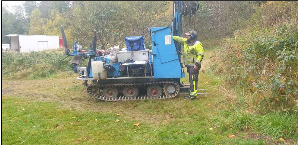
Figur 9. Jordprovtagning med borrhandsvagn i punkt M01.
