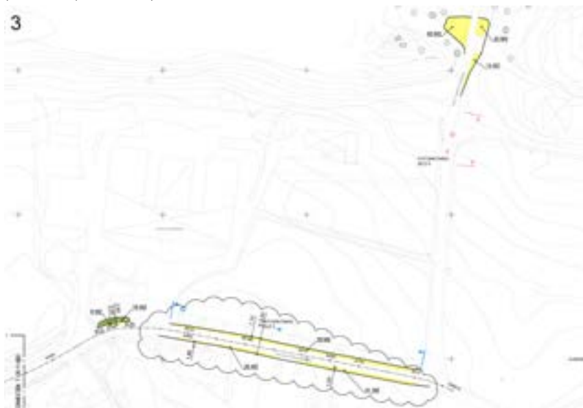
Nordöstra delsträckan där åtgärder i läge 7-8 avses utföras. Breddning av vägen och ny vändplats i nordost. (Norconsult, 2020-02-24)
