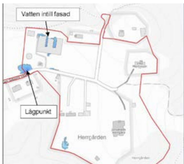
Befintliga lågpunkter inom planområdet inom blå skrafferade områden (Bild från dagvattenutredningen, Norconsult, 2024-02-23. (Källa: Scalgo Live))
