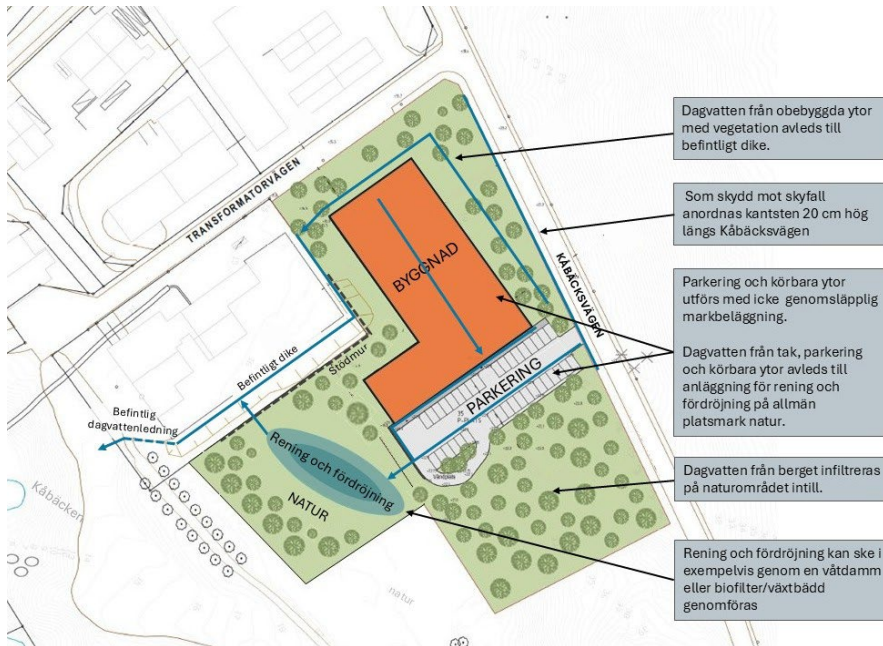
Bild 18. Konceptuell skiss som visar huvudprincipen för dagvattenhantering
