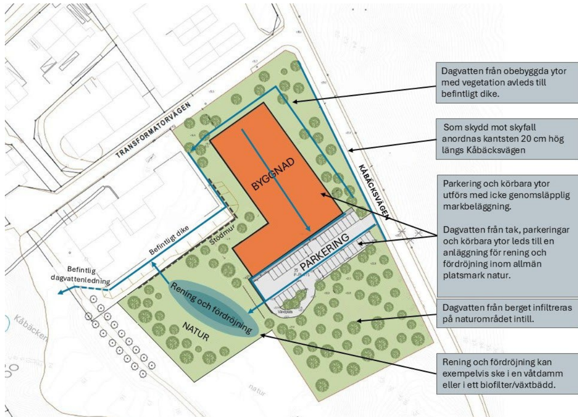
Bild 10. Dagvatten- och skyfallshantering, en principskiss.
