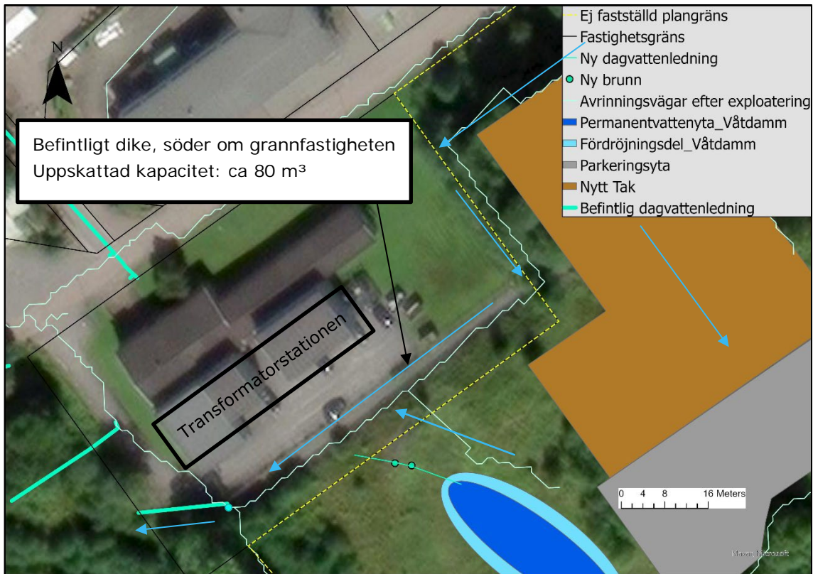
Figur 28. Dagvatten från norra delen av planområdet kan anslutas ytleddes tillsammans med husets dränering till det befintliga krossdiket söder om grannfastigheten (transformatorstationen). Bildkälla: ArcGIS Pro.
