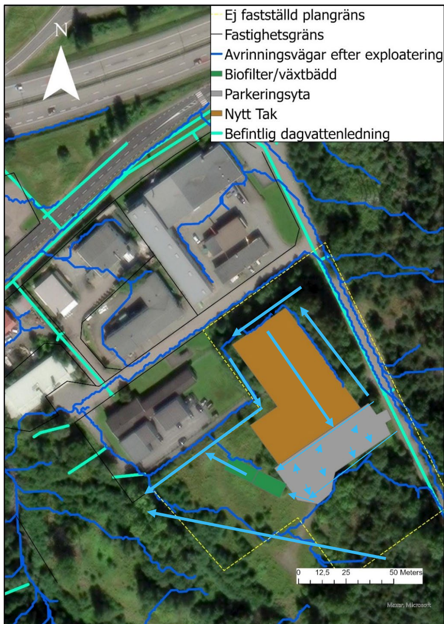
Figur 19. Framtida utformning av planområdet. Riktningen för avrinningsvägarna kan väljas enligt de blå pilarna. Placeringen och utformningen av växtbäddar är endast förslag. Bildkälla: ArcGIS Pro.
