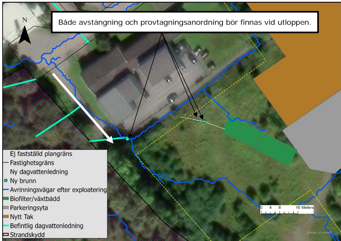
Figur 31. Utloppet från biofilteranläggningen kan anslutas till krossdiket. För att förhindra utsläpp av förorenat vatten vid olyckshändelser eller brand rekommenderas att utloppen från både växtbädden och krossdiket utrustas med varsin avstängningsanordning. Möjlighet till provtagning bör finnas vid utloppen från både växtbädden och krossdiket för att kunna kontrollera dagvattenkvaliteten vid behov. Den vita pilen indikerar en möjlig placering för en framtida serviceväg. Om en bypass-ledning anläggs parallellt med anläggningen för att leda stora flöden förbi denna, bör även denna förses med en avstängningsanordning. Bildkälla: ArcGIS Pro.
