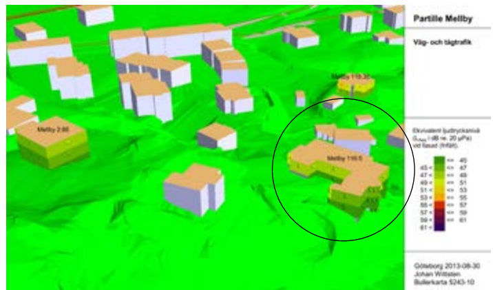
Fig. 2. Ekvivalent ljudtrycksnivå vid nordostliga fasaden från väg- och tågtrafik.
