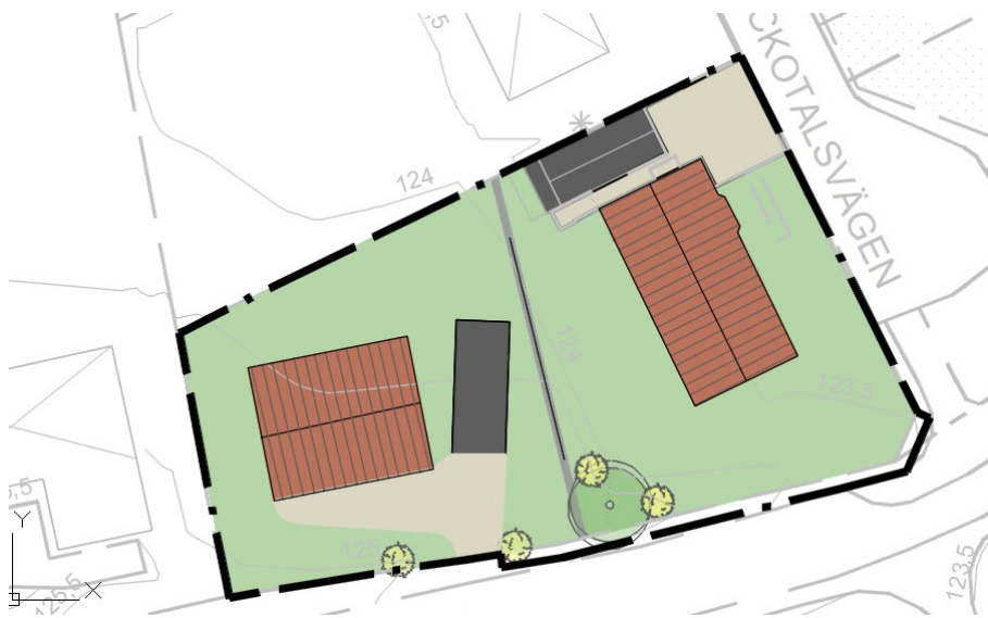
Figur.3 Illustrationskarta -Förslag med tänkbar tomtdelning samt placering av tillkommande hus inom planområdet
