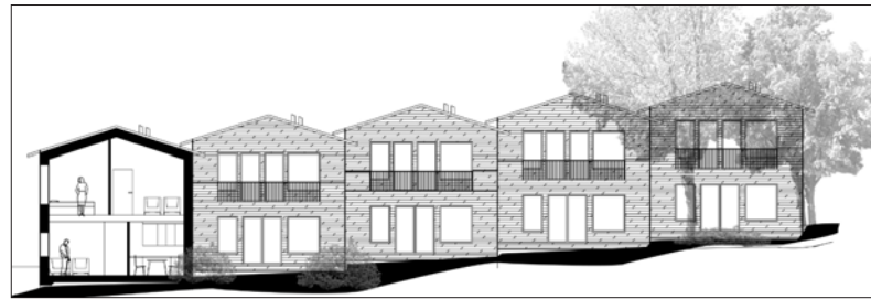
Bild 21, Fasaderna uppförs i tegel (Illustration: Studor).
