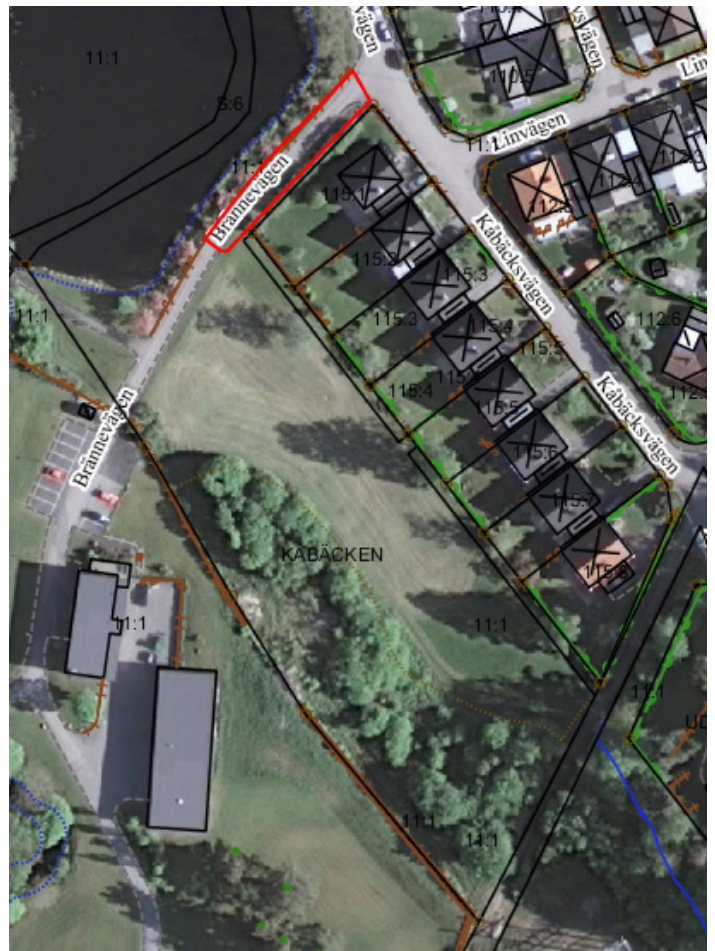
Bild 22, Del av Brännevägen som kommer breddas söderut från 3,5 meter till fem meter.
