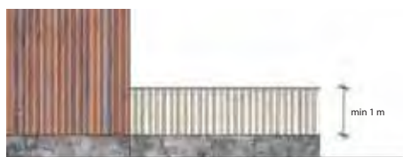
Naturstensmur och plank vid nivåskillnad mellan gård och gata.
