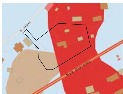
SGU:s jordartskarta. Rött är urberg, beige är kärrtorv och ljusblått är sandig morän
