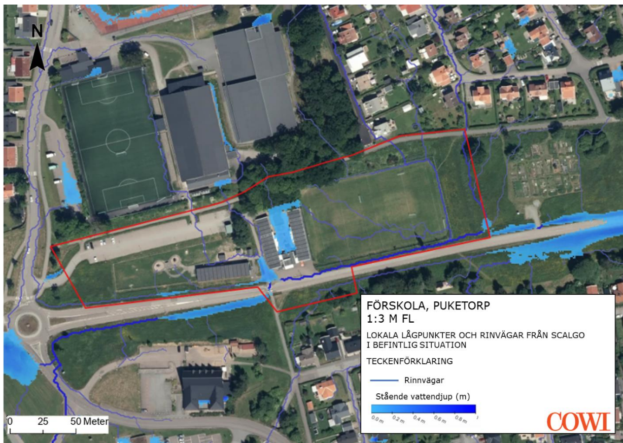
Figur 8. Lågpunktskartering utförd i SCALGO Live som visar lokala lågpunkter och stående vattendjup (m) och flödesvägar inom området vid ett klimatanpassat 100-års blockregn under 30 minuter (56 mm). Bilden visar befintligt förhållande. Bildkälla: SCALGO Live, bearbetad i ArcGIS Pro.
