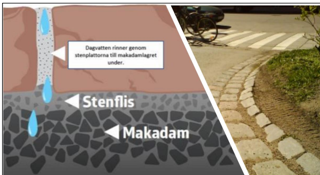
Figur 27. Till vänster: Krossdike på parkeringsyta. Bildkälla: Stockholm Vatten dagvattenstrategi, med hänvisning till Göteborgs Stads Kretslopp och vatten. Till höger: Makadamdike på parkering. Bildkälla: Svenskt Vattens Publikation (10)
